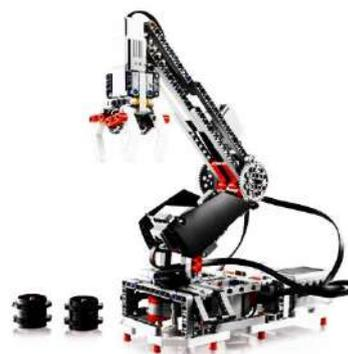
**Манипулятор** – механизм для управления пространственным положением орудий, объектов труда и конструктивных узлов и элементов.
