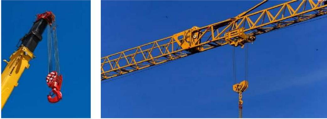
**Полиспаст** – натягиваемое верёвками или канатами грузоподъёмное устройство, состоящее из собранных в подвижную и неподвижную обоймы блоков, последовательно огибаемых канатом или цепью, и предназначенное для выигрыша в силе (силовой полиспаст) или в скорости (скоростной полиспаст)
