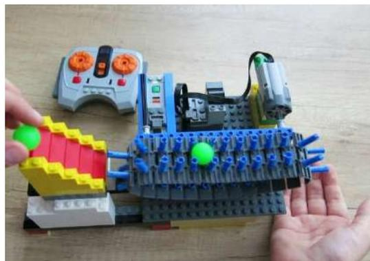
**Транспортер, элеватор** – транспортная машина непрерывного действия, перемещающая грузы в горизонтальном направлении или вверх под углом к горизонту по транспортной ленте или в транспортных сосудах (ковшах, люльках), прикрепленных к тяговому органу.
