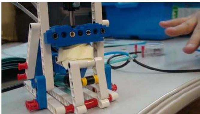
**Пресс** — механизм для производства давления с целью уплотнения вещества, выжимания жидкостей, изменения формы. На производстве прессы чаще всего используются, как устройство, позволяющее деформировать материалы с помощью механического воздействия для процесса штамповки. Штамповочные работы, штамповка, штампование — пластическая деформация материала с изменением формы и размеров тела. Чаще всего
