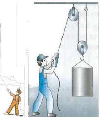
Если закрепить верёвку на станции (первая схема) и пропустить её через ролик на грузе, для поднятия груза необходимо усилие в 2 раза меньше, чем его масса. Выигрыш в
