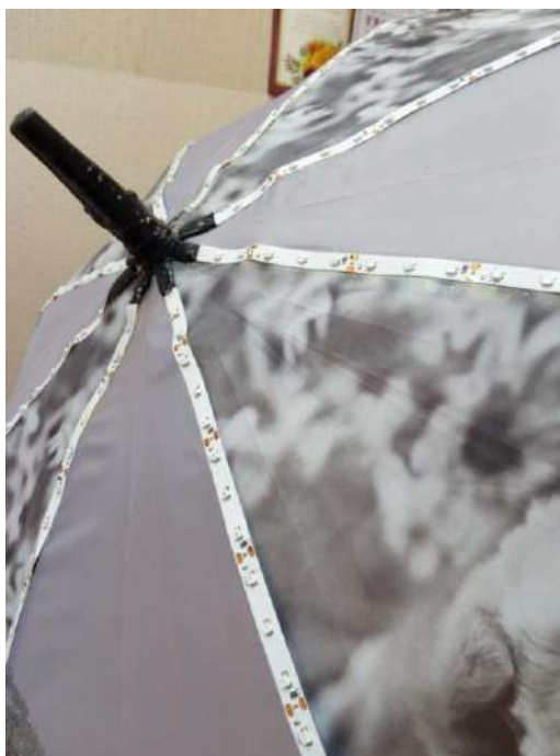
Рисунок 2.4 – Крепление полос к зонтику
