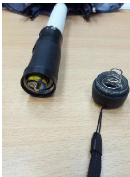
Рисунок 2.5 – Размещение батарейки в ручке зонта
