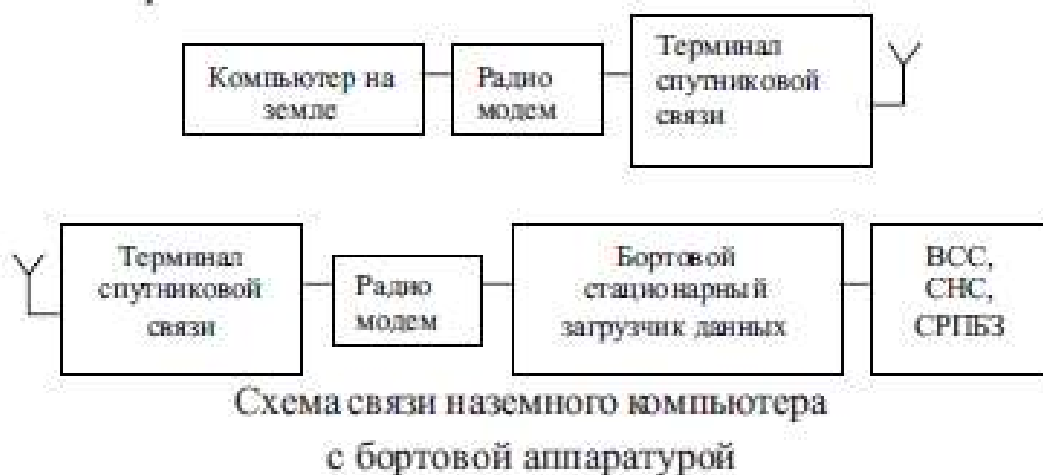
Рис. 3. Схема связи наземного компьютера с бортовой
